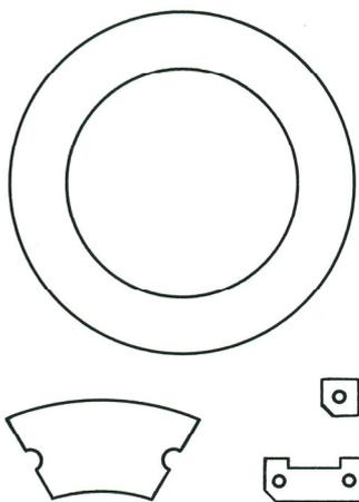
In der HF-Technik wird nur klarer Muskovitglimmer als hochwertiges Dielektrikum mit geringen Verlusten eingesetzt. Die Glimmerscheiben unterschiedlichster Formgebung werden sowohl für die Nieder- und Hochspannungskondensatorenfertigung als auch speziell für Leistungskondensatoren im Sender eingesetzt.
