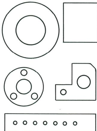
In der allgemeinen Elektrotechnik werden Glimmerscheiben der unterschiedlichsten Qualität und Formgebung als hochwertige Elektroisolation u. a. in Funkenstrecken, Überspannungsableitern usw. eingesetzt.
